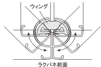
ラクパネ2枚をウイングで連結して立て簡易のA型看板を作成
